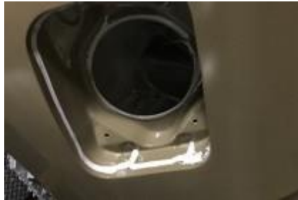
Figura 12. Sellado en compartimiento tanque de gasolina.
