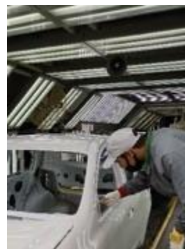
Figura 24. Reparación de sello embarrado en lijado filler.
